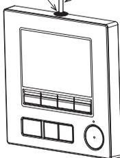
Far correre il cavo attraverso la parte superiore dell'unità di controllo remoto.
