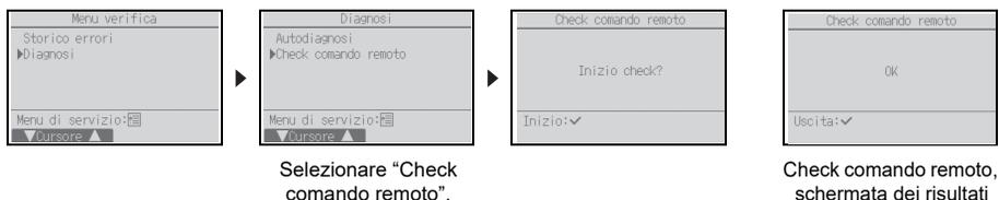
OK: Non sono stati rilevati problemi con l'unità di controllo remoto. Controllare l'eventuale presenza di errori su altri componenti.
