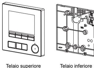
④ Collegare il cavo dell'unità di controllo remoto alla morsetteria sul telaio inferiore.
