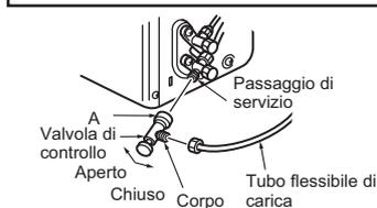
Al momento del fissaggio della valvola di controllo al passaggio di servizio, lo spillo della valvola può deformarsi o allentarsi nel caso venga esercitata una pressione eccessiva. Ciò può causare perdite di gas.
