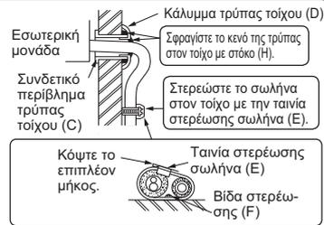
Αφού διενεργήσετε δοκιμή διαρροής, εφαρμόστε μονωτικό υλικό με τρόπο ώστε η περιοχή να καλυφθεί καλά και να μην μείνει κανένα κενό.
