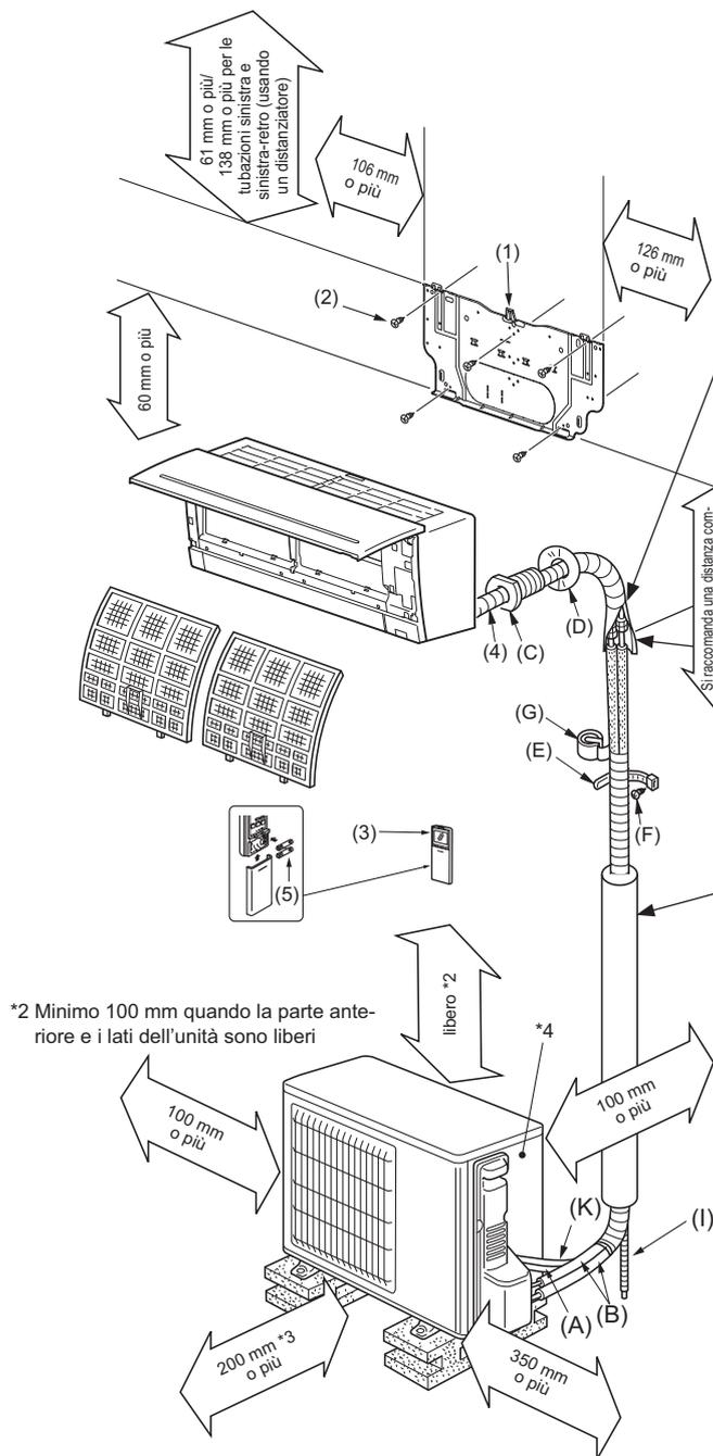
Avere cura di utilizzare la manica foro muro (C) per impedire il contatto tra il cavo di collegamento interno ed esterno (A) e le parti metalliche nel muro, nonché per prevenire danni causati da roditori nel caso in cui il muro sia cavo.
